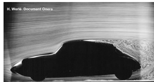
Ecoulement dans le sillage d'une maquette d'automobile
