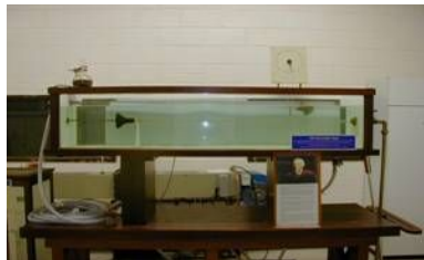
Banc expérimental utilisé par Reynolds, exposé à l'Université de Manchester (UK)
